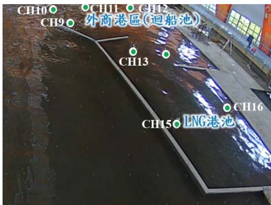
圖 6 夏季季風試驗情形(外商港區與 LNG 港池)
