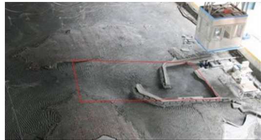
圖 1. 動床試驗的地形幾何表面幾無可辨識特徵
