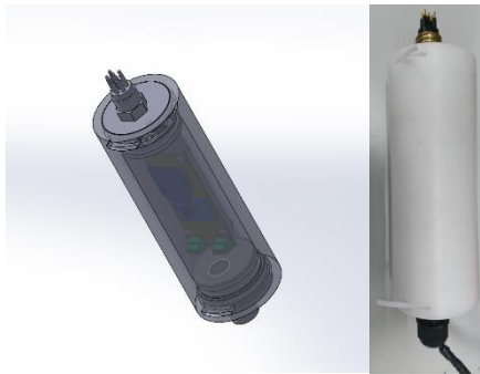
圖 2 RF 模組水密艙設計(左) 與成品(右)
