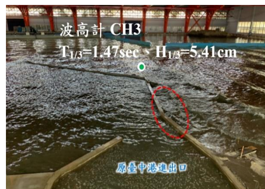
圖 4 冬季季風試驗情形(北防波堤)
