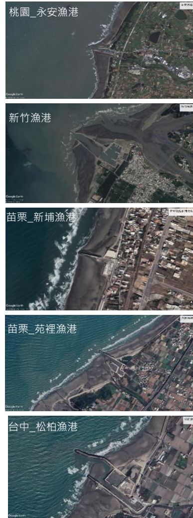
圖 6 臺灣西部桃園永安、新竹、苗栗新埔與苑裡及台中松柏等漁港之配置與毗鄰海灘之沖淤型態 (圖資來源：GoogleEarth，2015/12、2018/10、2021/02、2018/11、2018/11)
