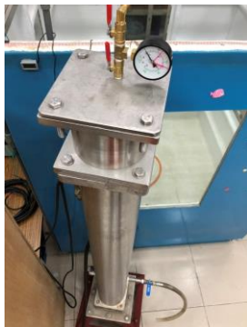
圖 2 可加壓充水阻抗管
