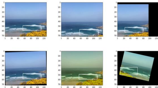
圖 7 離岸流原始影像之影像擴增技術，左上：原始影像、中上：隨機等比縮放、右上：隨機位移、左下：隨機旋轉、中下：隨機色調轉換、右下：隨機套用。
