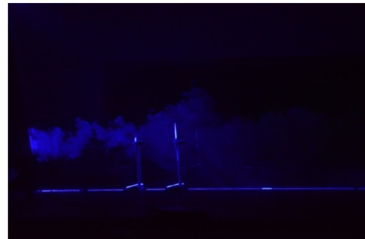
圖 2 雷射光頁照明單支風力機在紊流邊界層內之尾跡流煙流示現
