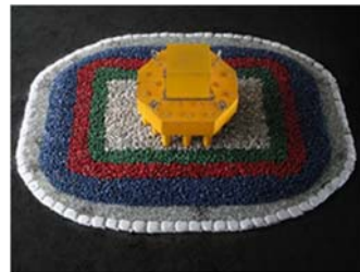
圖 10 群樁式基座保護工型式示意圖
