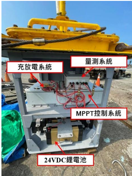
圖 6 通訊浮筒監測模組
