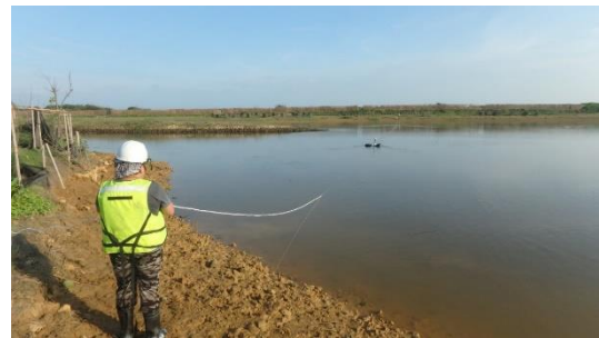
圖 5 全潮測量上游断面之施測照片
