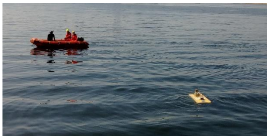
圖 6 IUT-AUV I 於台南安平港進行 ASV 模式之航點導航測試
