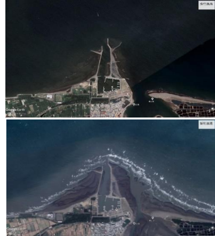
圖 8 新竹漁港高潮位(上, 2018/07)及低潮位(下, 2018/04)期間沙舌型淤積之近岸淺灘(圖資來源: Google Earth)
