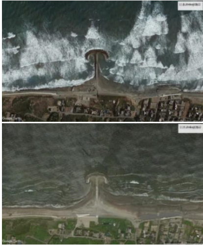
圖 5 日本 Jinkoji 海岸之單 T 型突堤與碎波帶內之卓越入射波浪(上)及因離岸堤效應導致毗鄰突堤淤積之繫岸沙洲型態淺灘(下)(圖資來源：Google Earth，上_2017/01；下_2018/05)
