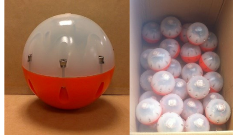
圖 3 本研究自主研製之微型化漂流資料浮標
