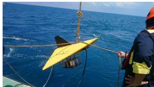
圖 2 裝載自製換能器陣列之拖體
