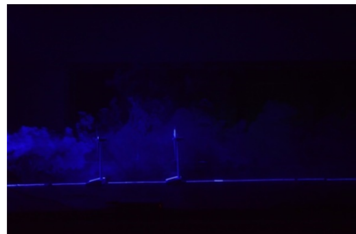
圖 3 雷射光頁照明之風力機尾跡流煙流示現；二支風力機排列，上圖間距 2D，下圖間距 4D
