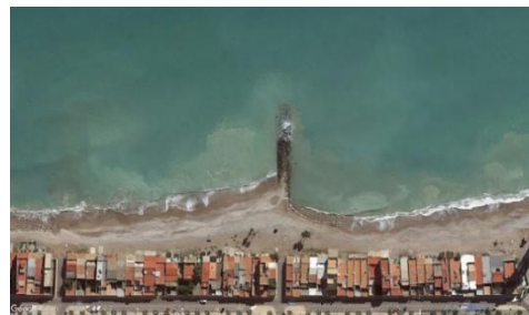
圖 3 突堤效應導致之海灘沖淤(圖資來源：西班牙 Platja de Nules, Castelló, 2015/10)
